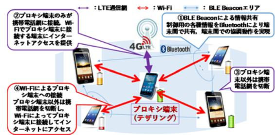
図1 端末間協調省電力フレームワークの概要
