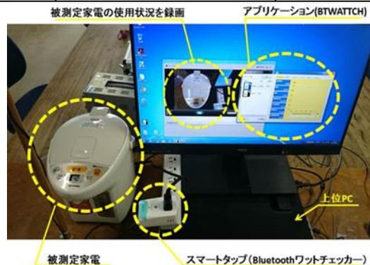
Fig.2 被測定家電の消費電力量の測定風景
