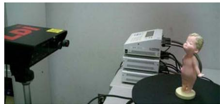
図 9 実験に用いたレンジファインダ
