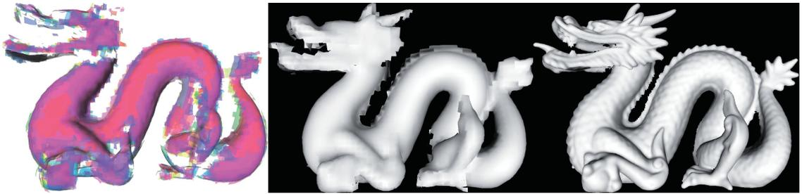
図 7 提案手法により粗く位置あわせした結果(左)を同時位置あわせすることにより, 統合形状モデル(中)が得られる. サンプル間隔を細かくすることにより, より精細な統合形状モデル(右)を生成することができる
