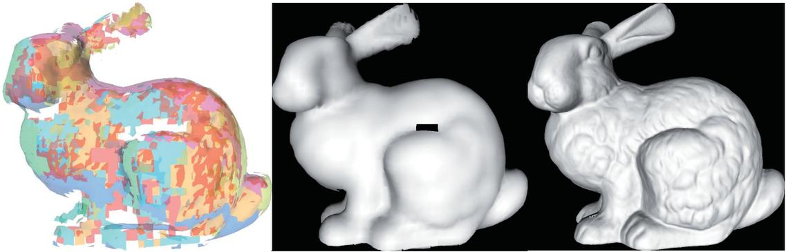
図 6 提案手法により  $\delta = 4$  mm の粗さで位置あわせされた入力距離画像 (左). これを初期値として, 同時位置あわせ手法によって統合した形状モデル (中). さらにその結果を初期値として, サンプリグ間隔を  $\delta = 0.5$  mm に細かくして生成した精細な形状モデル (右)
