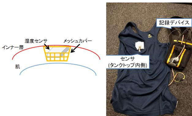
図1 簡易湿度センサ手法概要
