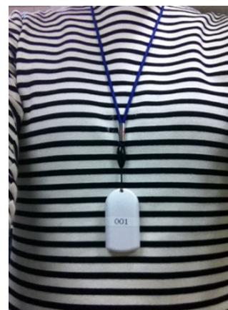
図 4. BLE モジュール子機の装着の様子
