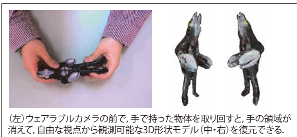
図-3 手持ち物体のモデリング 出典:3-D Digitization of a Hand-held Object with a Active Wearable Vision Sensor 5)
