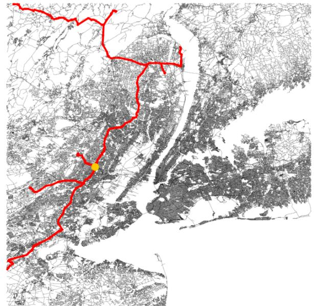
図 2 強最短路木の具体例. 道路ネットワークは 9th DIMACS Implementation Challenge [9] により提供されているニューヨークのものである. 赤太線が強最短路木であり, 丸で示したノードは後述の Algorithm 1 における根である.
