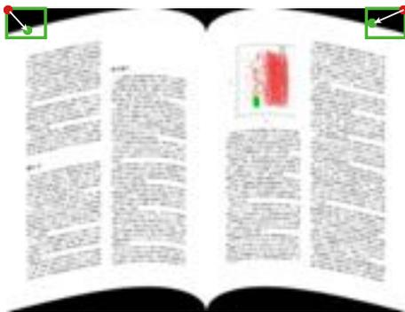
図 7 射影変換のためのパラメータ決定の手順. 画像の右上および左上の端点 (赤点) を, それぞれ縦横 10% の大きさの領域 (緑枠) 内から無作為に決定した任意の点 (緑点) に変換するようなホモグラフィ行列を推定し, 射影変換を行う.
