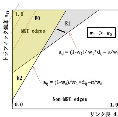
図3 パラメータ  $w$  による選択されるリンクの特性変化
