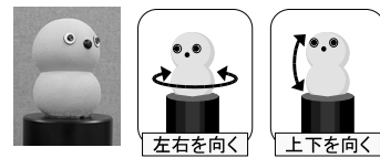
図 3 ロボット Keepon と、本研究で動作生成に用いた 2 自由度
