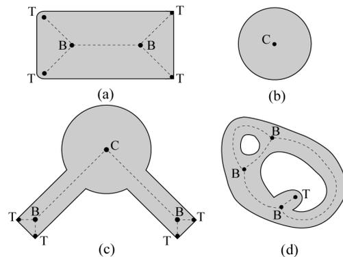
図2: スケルトン構成要素の例 (T: 端点 B: 分岐点 C: 円中心)
