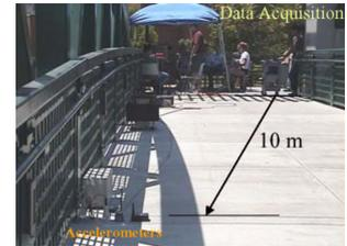
図6 UCIにおける橋脚の振動測定
