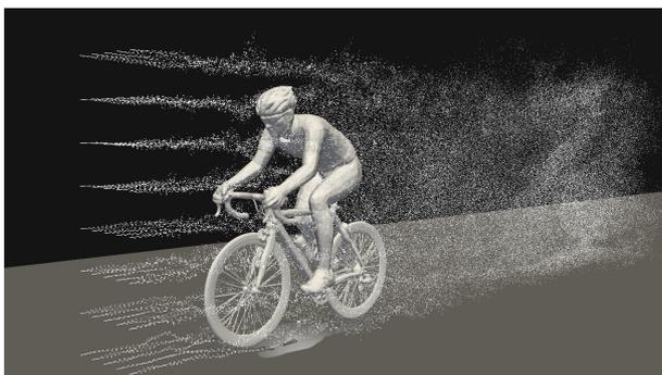
図 9 複雑形状物体周りの流れの計算結果
