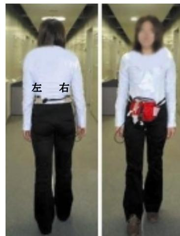
図1 携帯用左右同期型加速度センサーシステムによる歩行計測
