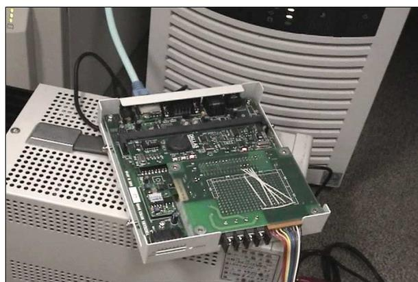
図3 自作回路を加えた情報家電コントローラ
