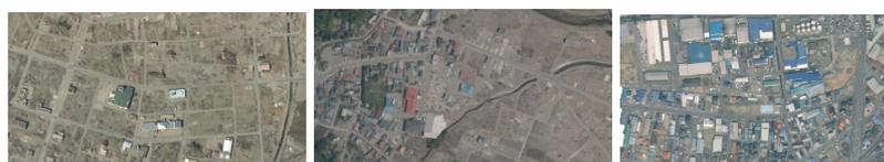
図 2 使用空撮画像の例（左から，建造物がほぼ倒壊，倒壊と非倒壊が混在，ほぼ非倒壊の地域）
