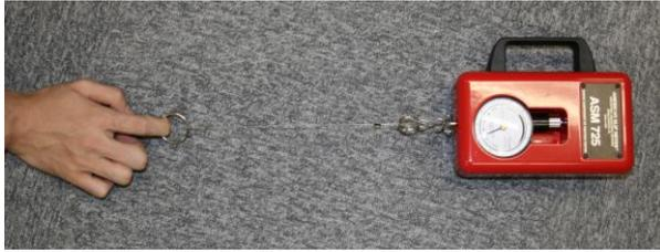
図 8 製摩擦係数の測定
