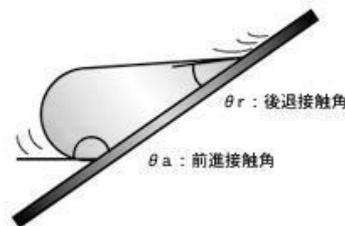
図1 前進接触角・後退接触角
