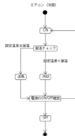
図 2: エアコン (冷房) のステートマシン図
