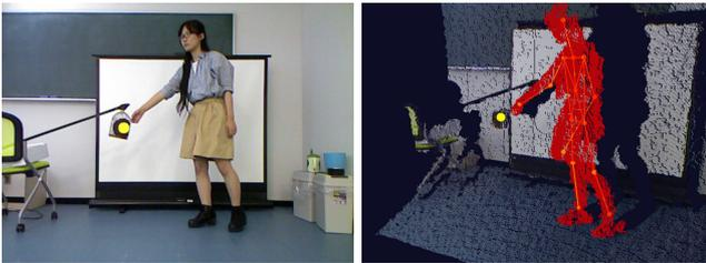
図 5 虫かごの識別結果 (黄色の点)
