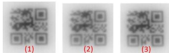
図 14 QR コードが焼き付けられた 3 枚の皿から抽出された QR コードの画像
