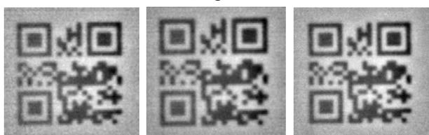
図 13 画像処理後(左:300mA,中央:400mA,右:500mA)
