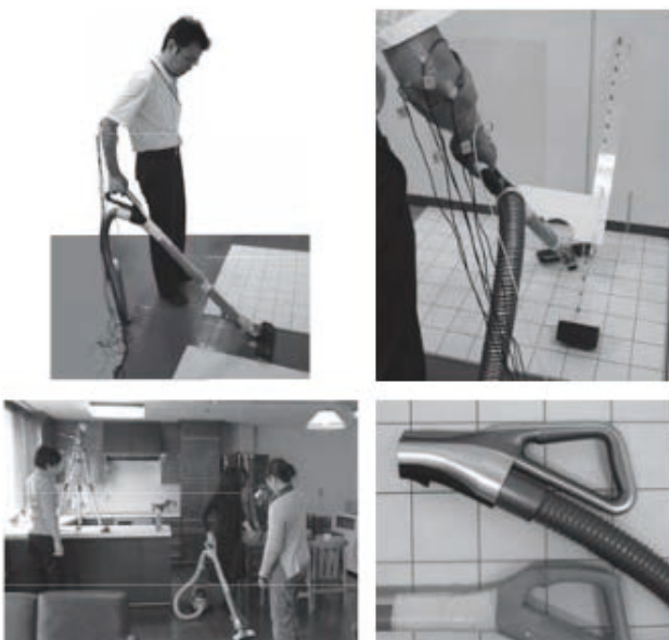
図5 試作したデザインの身体負担を計測する実験
