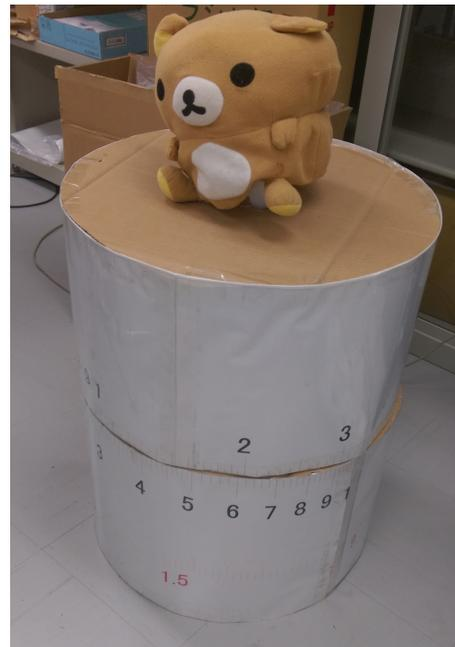
図 2 学生が発案・制作した大型の円筒形計算尺。A1 ロール紙に計算尺の C-D 尺にあたる 1 桁の対数目盛を印刷し、段ボール製の円筒に巻きつけている。側面は透明なプラスチック板で補強されている。
