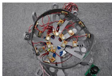
図 5 振動モータを使用した全天型モデルのデバイスイメージ
