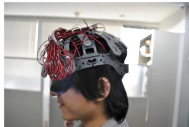
図 4 振動モータを使用した全天型モデルのデバイス装着イメージ
