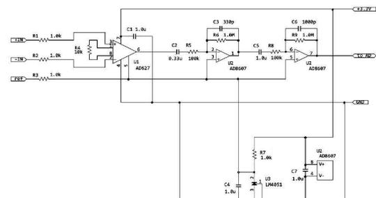
図1 新筋電センサ回路
