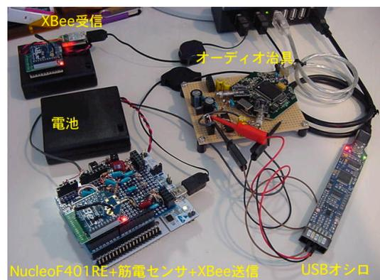
図2 新筋電センサシステムによる実験の様子
