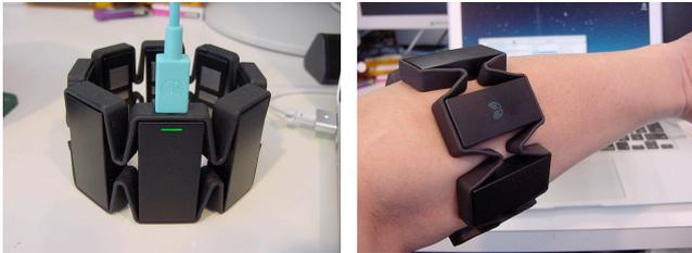
図3 筋電センサ“Myo”
