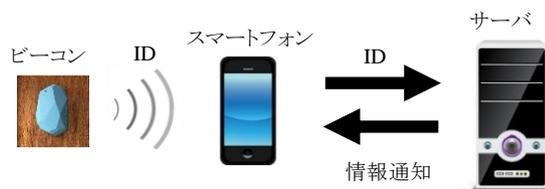
図 3.2 iBeacon を用いた位置情報サービス
