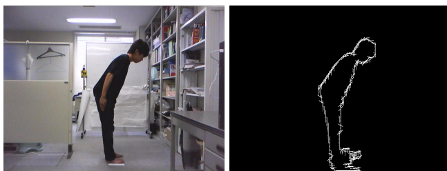
図 4 HOG 特徴量の抽出 Fig. 4 HOG Extraction.
