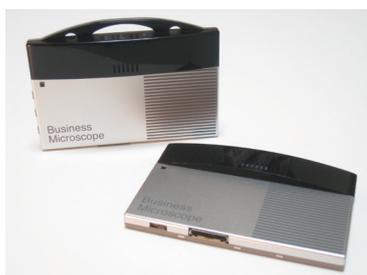
図1 ビジネス顕微鏡の名札型センサ端末
