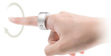
図4 装着型加速度センサの例 [7]より
