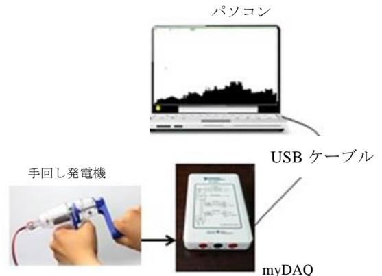
図 2 ゲームのシステム構成
