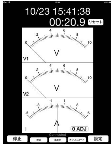
図3 iTester アプリの電圧・電流のメータ表示画面
