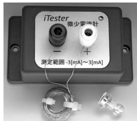
図9 試作した微小電流計(測定範囲 $\pm 3$ [mA], 分解能0.125[ $\mu$ A])。写真のコイルと書類止め用磁石で電磁誘導の様子を観察できる。
