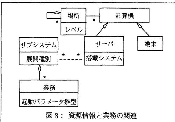
業務のサーバへの展開は全社に1台・拠点毎・フロア毎・部署毎に1台、といった少数のパターンに帰着される。端末の所在・個人の配属先・起動対象業務の展開種別を照合してサーバを決定し位置透過程性を実現する。業務の起動パラメータは端末・ユーザ属性を埋め込んだパラメータ雛型を用いて決定する。社員番号・端末ID等・所属等の情報を動的に起動パラメータに反映する。
