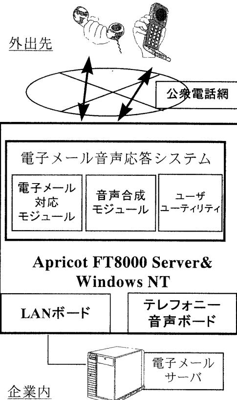
究開発しているソフトウェアを採用した。音声を電話に読みだし、また電話からのプッシュトーンを受け取れるインターフェースとして、PC/AT互換コンピュータに装着するタイプの音声ボードで電話インターフェースをもつものを採用した。これらを搭載するサーバーのオペレーティングシステムには Microsoft® Window NT®を採用した。
