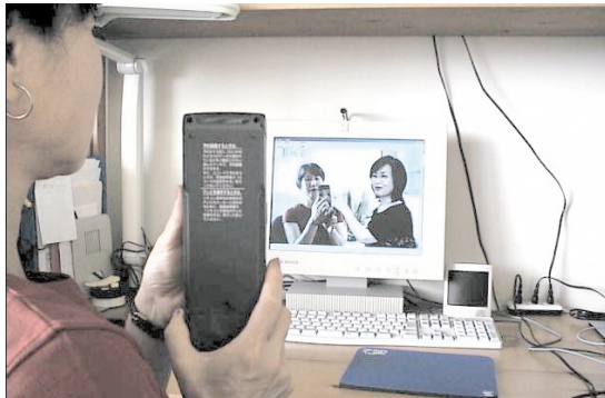
図 4 机上型超鏡システムの例。14 型の液晶モニターと小型カメラ。リモコンの操作方法を教示している様子
