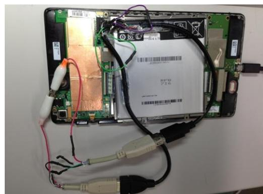
図 3 電流計測用加工済端末
