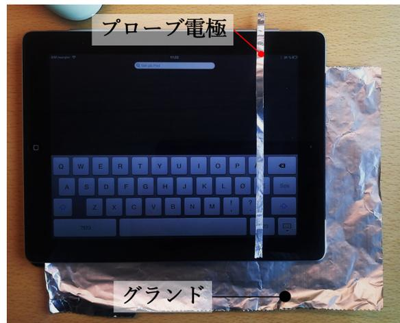
図 A.1 Tx に流れる信号を測定するための電極配置
