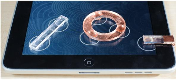
図 1 iPad 上の PUCs widget. ブリッジマークでの実装 (左) とリングマークでの実装 (中央). 右は iPad の適応的なフィルタを無効化するためのタッチ点
