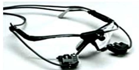
図1 視線計測装置のセンサー部
