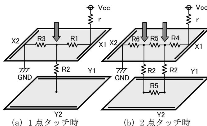
図1 2端子方式の等価回路
