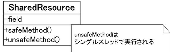
図 1: SingleThreadedExecution パターンのクラス図
