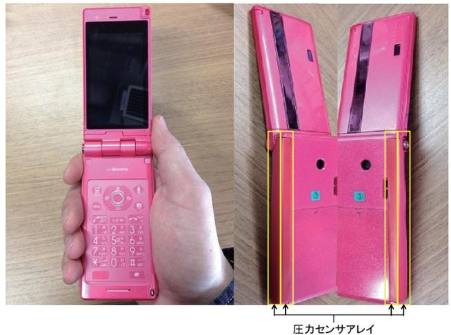
図1 圧力センサを搭載した携帯端末
