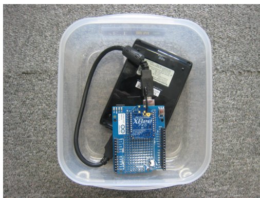
図 6 測定に使用した Arduino UNO, Xbee Pro, バッテリー (シール容器に格納したもの)
