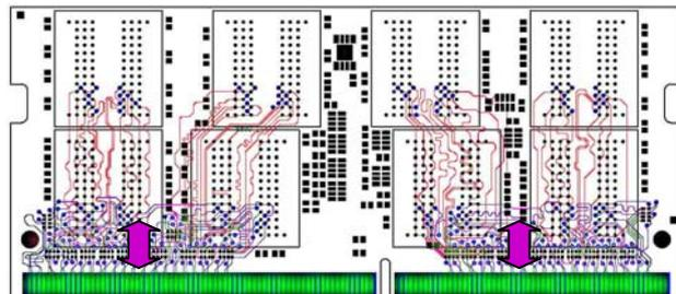
データはカードエッジから各DRAMへ最短で接続される。同じバス上に他のモジュールなどの負荷が存在する場合に反射の影響を軽減するため直列抵抗が挿入されている。
