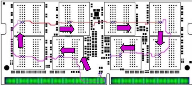
Fig-3: クロック信号配線例
