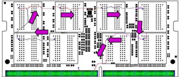
ALERT は、クロック、アドレス、コマンド、コントロールとは逆向きでシステムに接続される。
