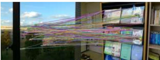
図 11 図 10 から最近傍の特徴量の点を対応させた画像
