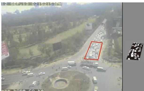
図-6 Web カメラの画像内の赤枠の部分の二値化の結果
