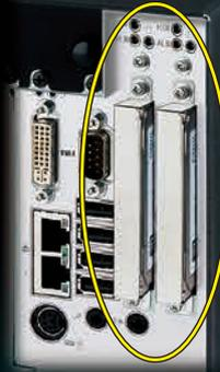
RAID対応のPCI Express / PCI混載モデル、PCI Express(専用)モデルもあります。
