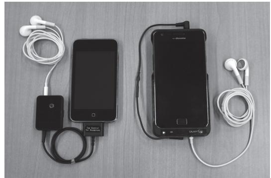
図 6 製作したプロトタイプ。iPod touch に接続するアダプタとしての実装 (左) と、Galaxy S II 用のスマートジャケットとしての実装 (右)
