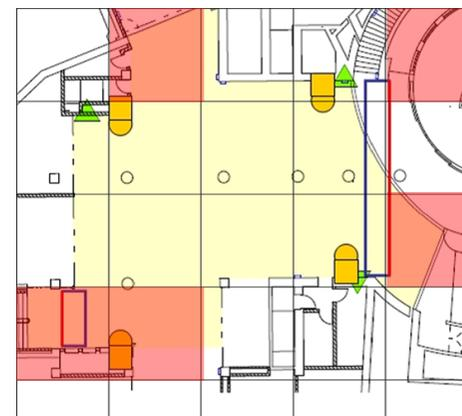
図 3 計測領域をセルで分割し、出入口セルを選択した様子
