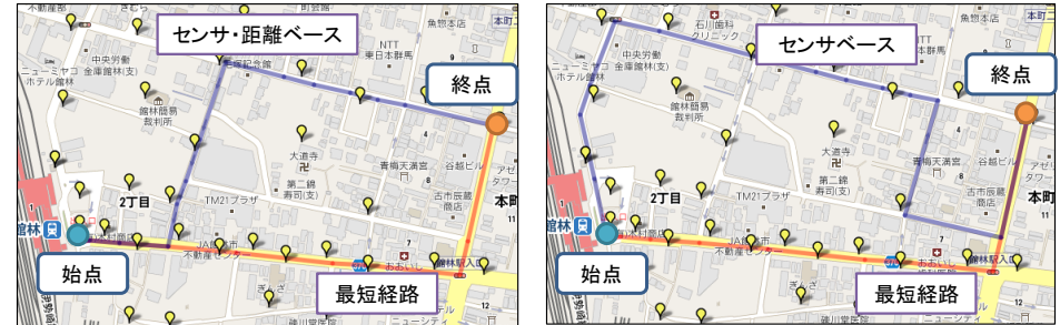
図 8 生成経路(左:センサ・距離ベース手法 右:センサベース手法)
