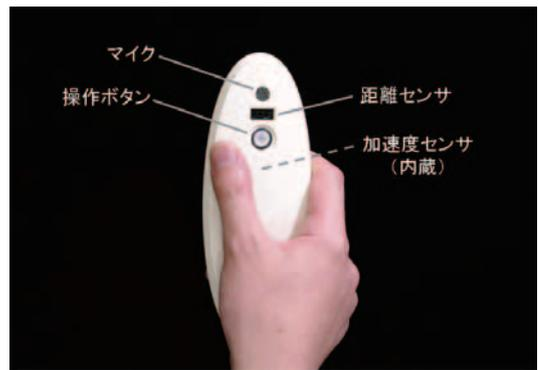
図-1 試作したセンサ内蔵リモコンデバイス
